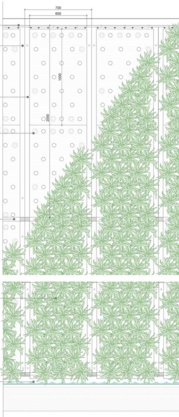
El sistema F+P está compuesto por paneles SG-L40 de sustrato inerte, específico para jardinería vertical hidropónica, fijados mecánicamente a paneles impermeables de soporte SG-P35 que se anclan a la pared de soporte.
