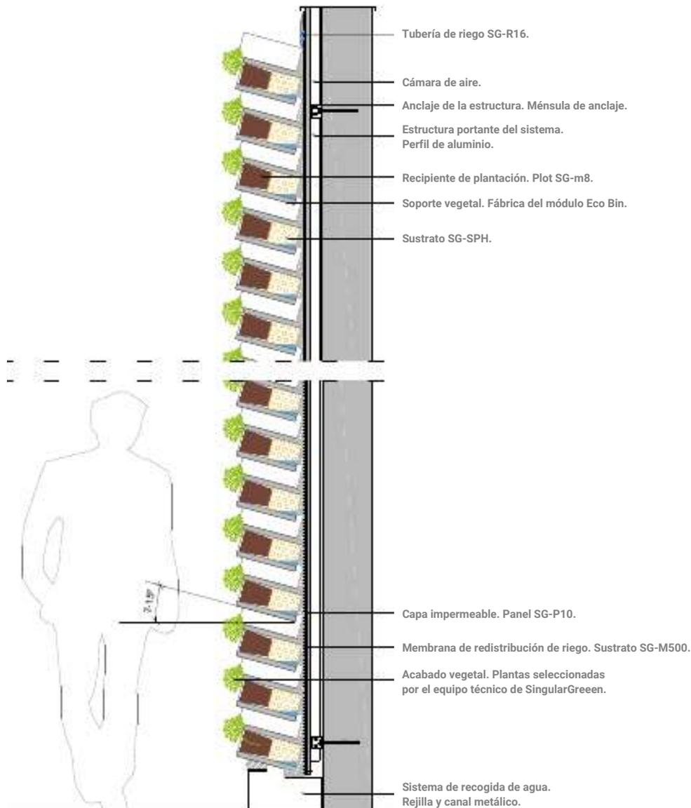
Sistema EcoBin está compuesto por estructura portante, panel impermeable, membrana de redistribución del riego y medio de plantación formado por fábrica de botelleros cerámicos con sustrato aireador y retenedor. Acabado vegetal de especies seleccionadas para el clima de la zona.
