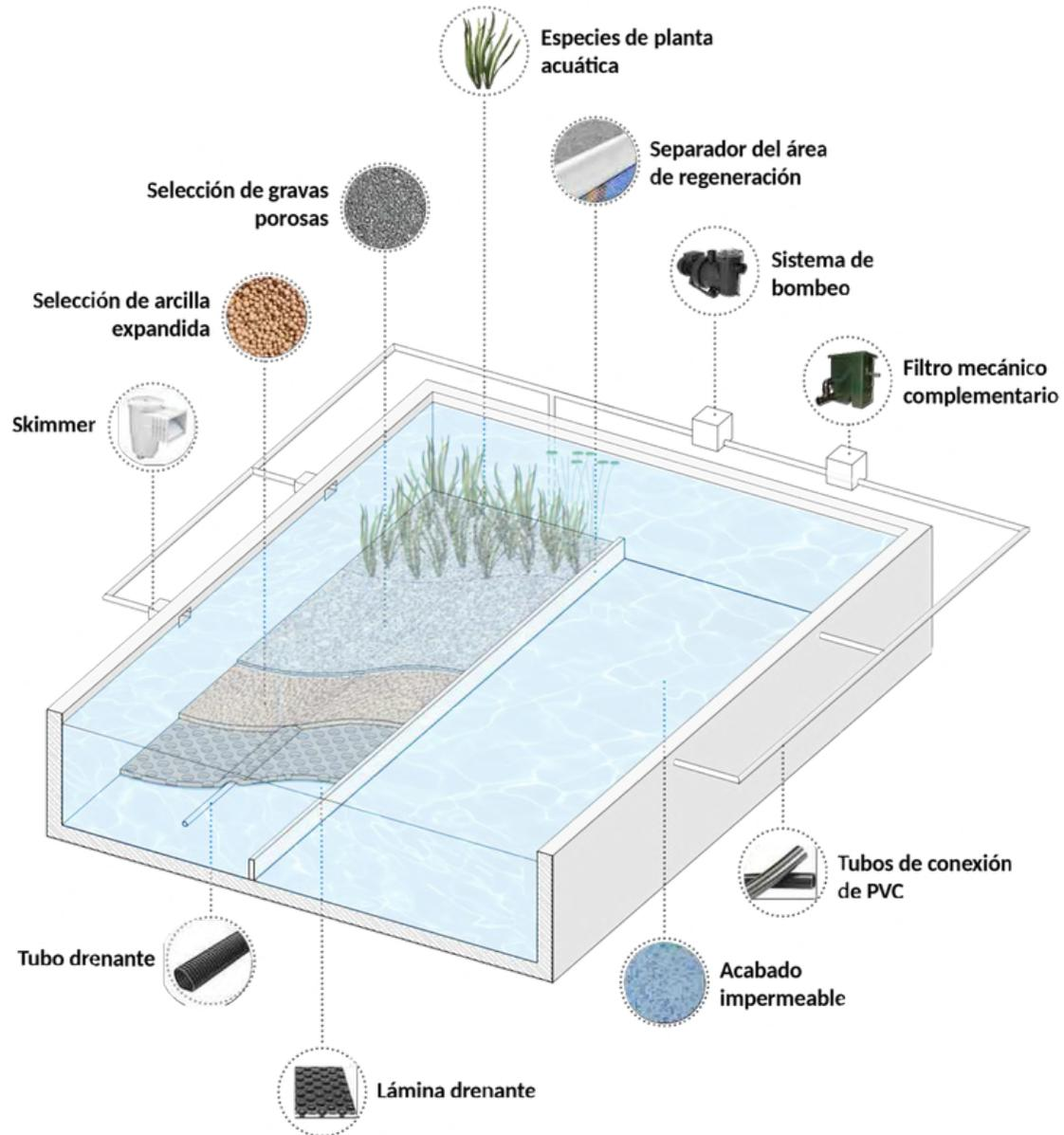
Esquema piscina de nueva construcción, en el caso de Sección constructiva. Filtro biológico de planta sumergida conversión de piscina mediante filtro biológico, el esquema será diferente.
